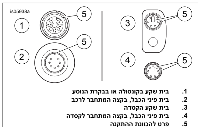
תרשים 5. פריטים להכוננת ההתקנה של מחבר כבל האוזניות
