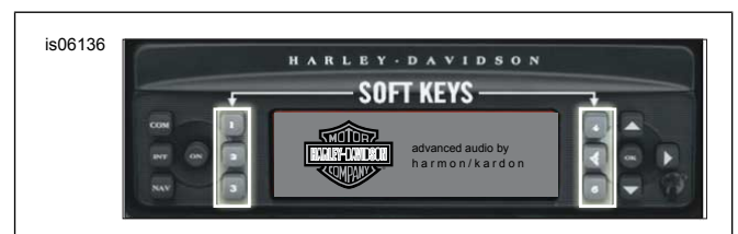
תרשים 2. מקשים רכים של מקלט שמע מתקדם
