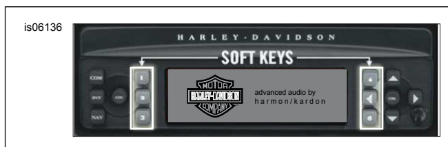
Figura 2. Tasti funzione programmabili del ricevitore Advanced Audio
