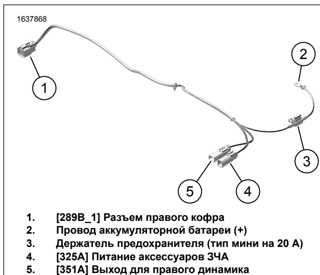
Рисунок 15. Внешний жгут проводов 69202870
