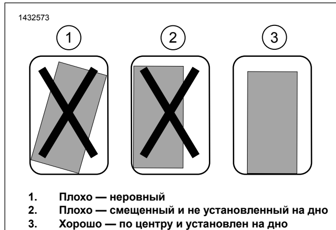
Рисунок 11. Установка монтажного кронштейна
