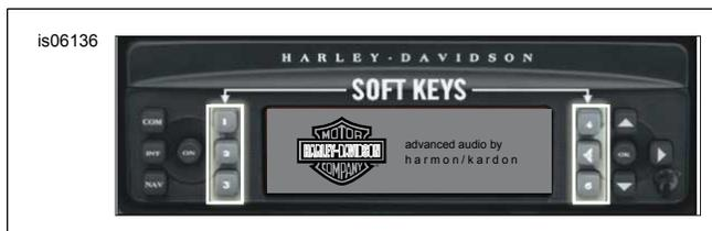
Рисунок 2. Сенсорные клавиши ресивера усовершенствованной аудиосистемы
