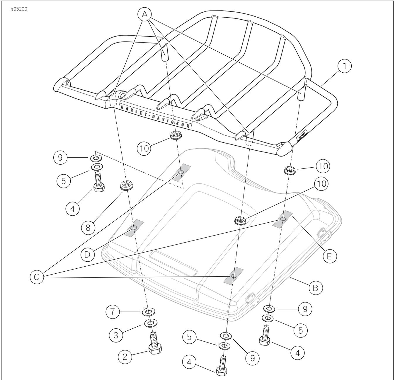
圖1。維修零件，Air Wing Tour-Pak蓋行李架
