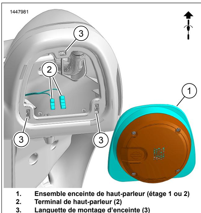
Figure 2. Installation du haut-parleur de carénage inférieur
