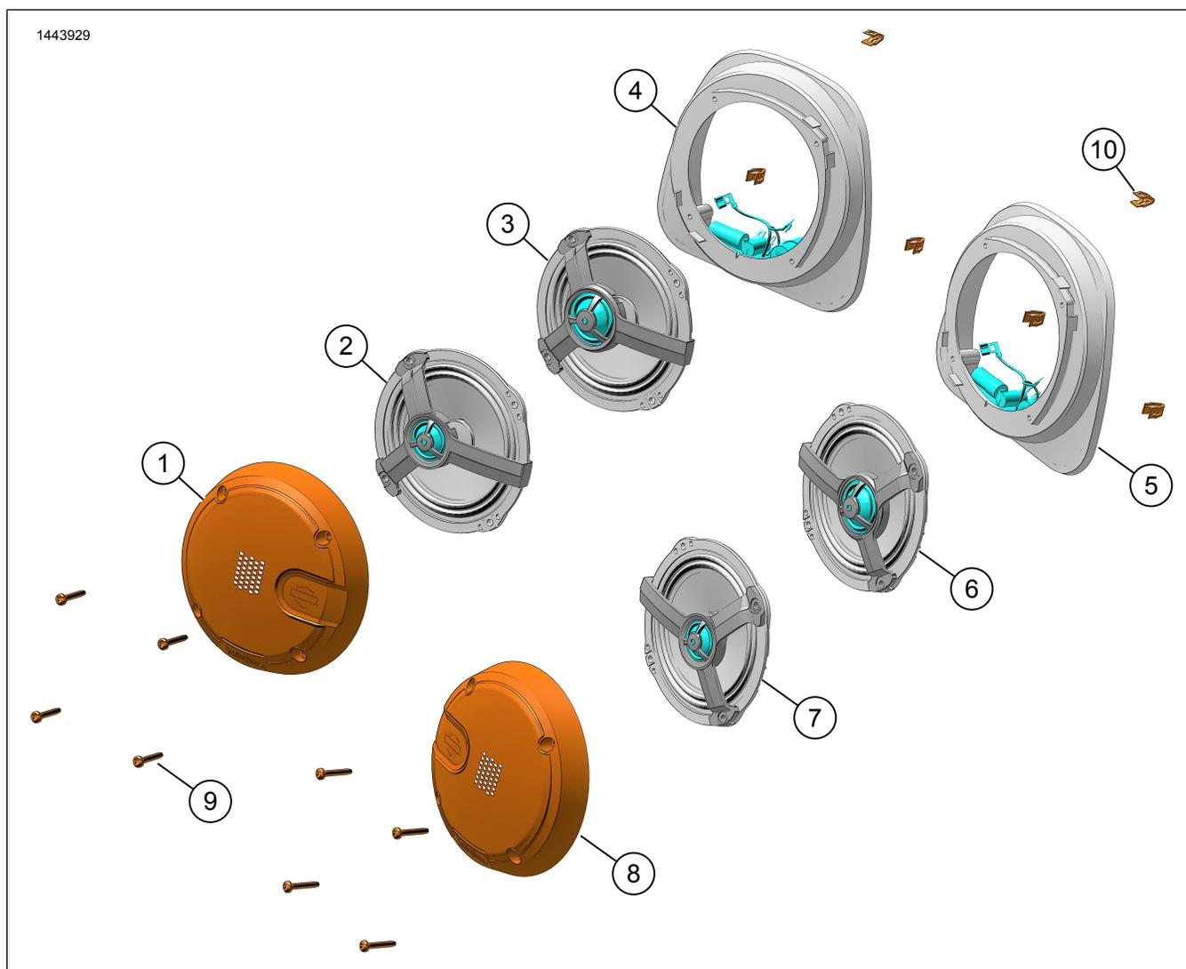
Figure 4. Pièces de rechange, Haut-parleurs inférieurs de carénage
