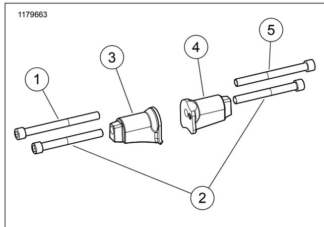
Abbildung 10. Ersatzteile: Satz 50501118
