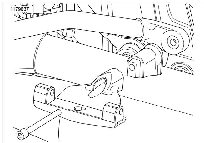
Abbildung 7. Satteltaschenschutzbügel mit der langen Schraube
