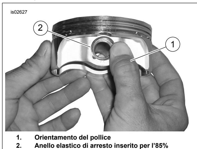
Figura 4. Installazione dell'anello elastico d'arresto
