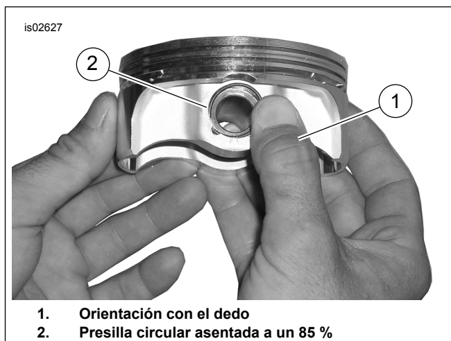
Figura 4. Instalación de la presilla circular
