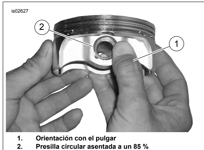
Figura 4. Instalación de la presilla circular
