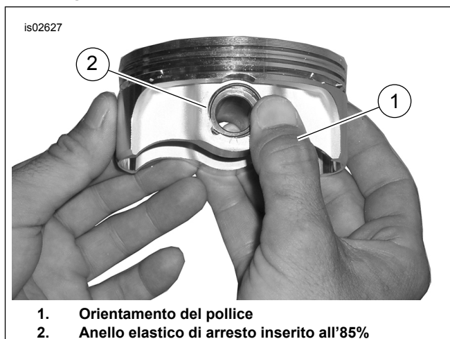
Figura 4. Installazione dell'anello elastico d'arresto
