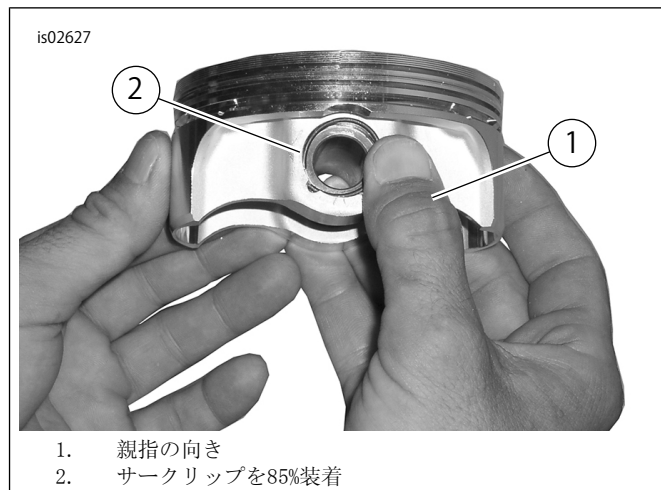
図4。サークリップの取り付け
