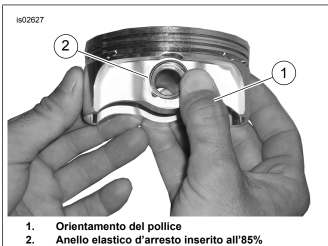
Figura 4. Installazione dell'anello elastico d'arresto
