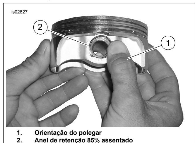
Figura 4. Instalação do anel de retenção
