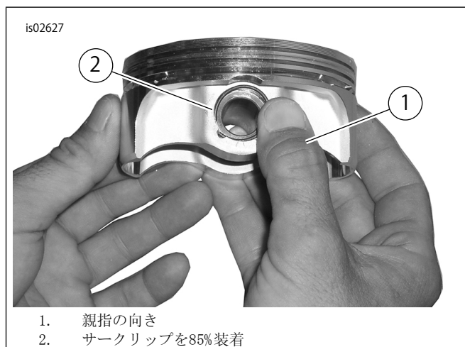
図4. サークリップの取り付け
