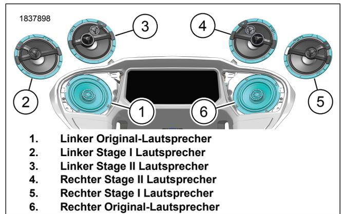
Abbildung 4. Lautsprecherausrichtung (typisch)
