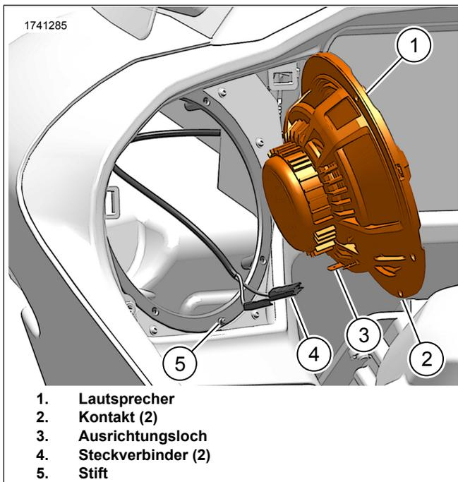
Abbildung 3. Anschluss Verkleidungslautsprecher
