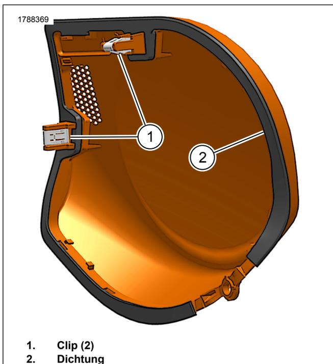
Abbildung 6. Gitterdichtung
