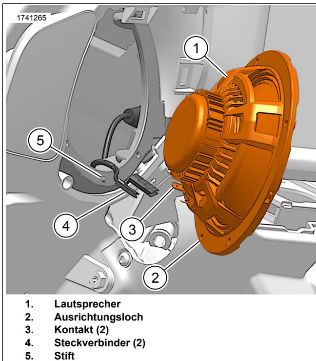
Abbildung 4. Anschluss Verkleidungslautsprecher
