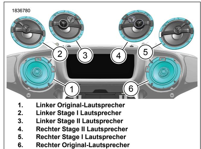
Abbildung 5. Lautspecherausrichtung (typisch)
