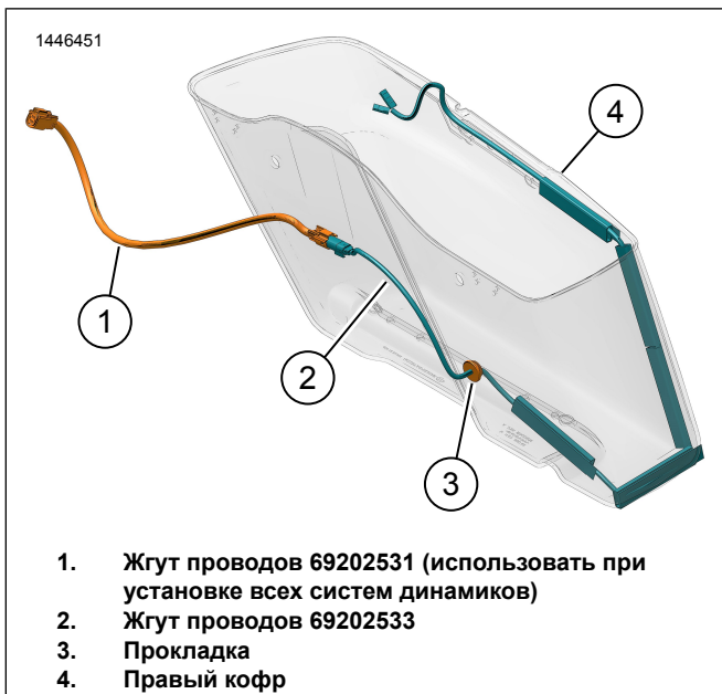
Рисунок 5. Укладка проводов в правом кофре (без усилителя)
