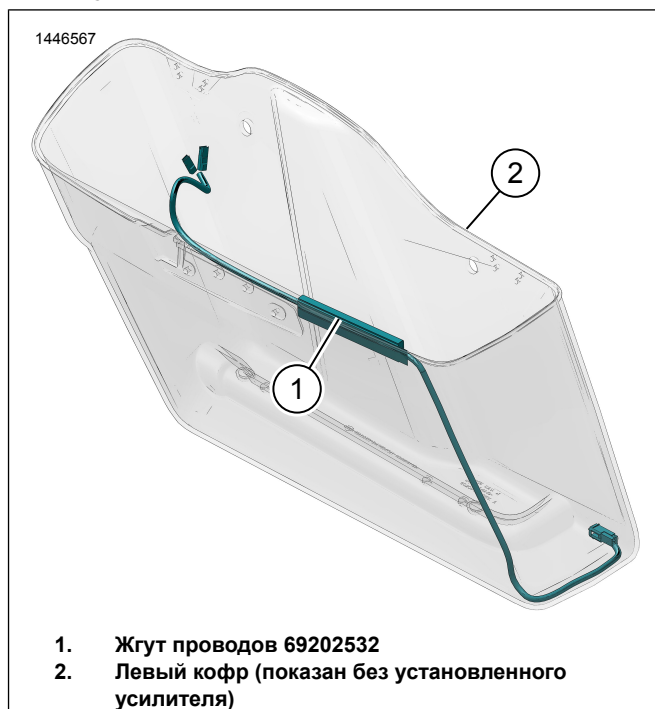
Рисунок 4. Укладка проводов в левом кофре
