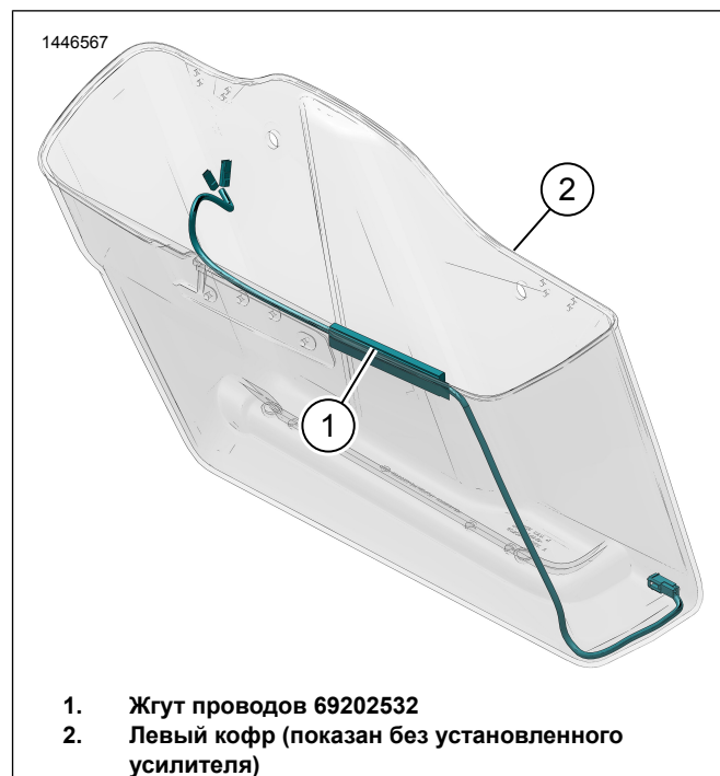
Рисунок 8. Укладка проводов в левом кофре
