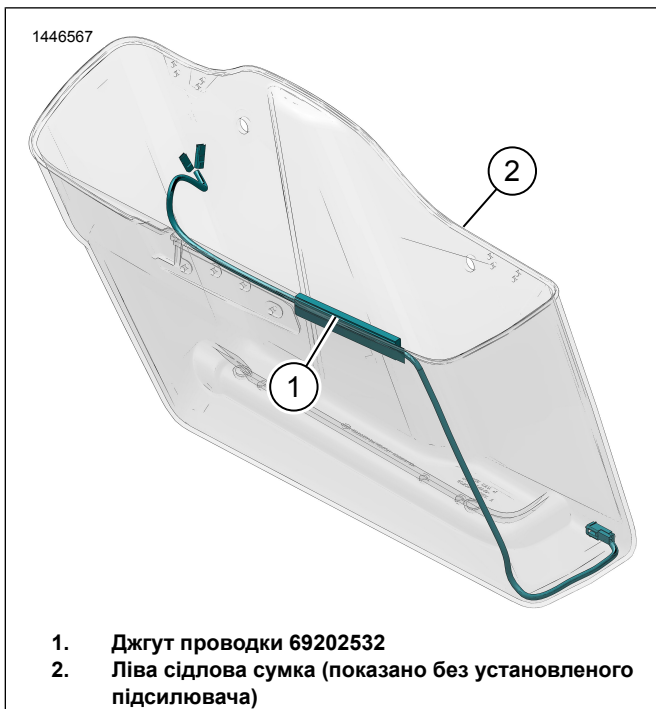
Малюнок 4. Прокладення джгута лівої сідлової сумки
