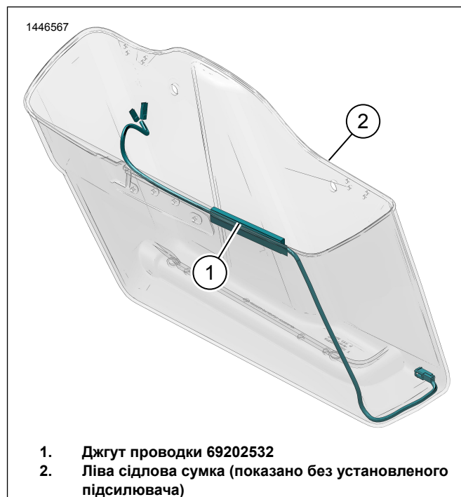
Малюнок 8. Прокладення джгута лівої сідлової сумки
