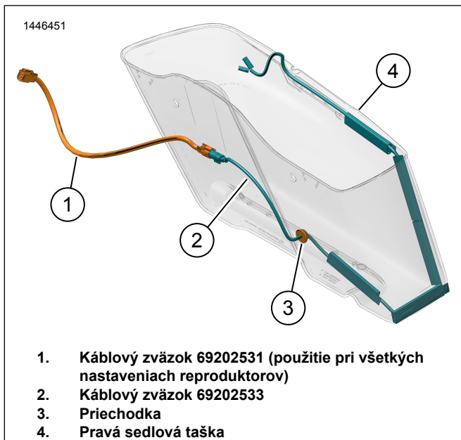
Obrázok 5. Trasa zväzku pravej sedlovej tašky (bez zosilňovača)
