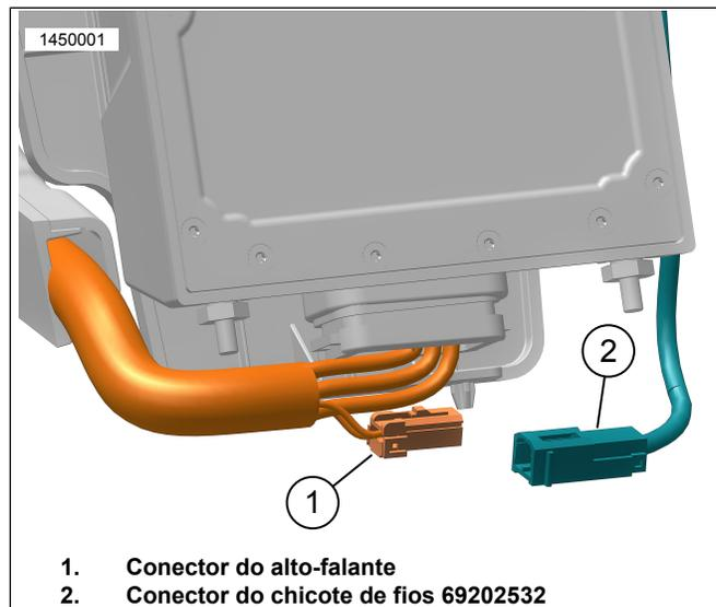
Figura 7. Conexão do alto-falante do alforje esquerdo, semelhante à direita
