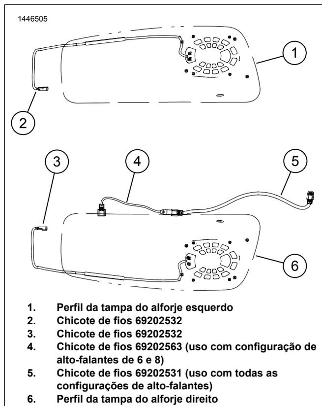
Figura 6. Configuração e orientação do chicote de fios
