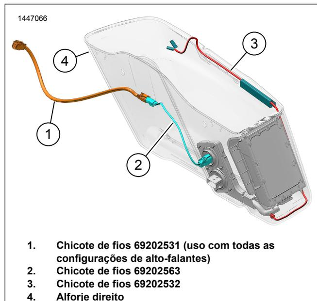
Figura 9. Orientação do chicote de fios do alforje direito (com amplificador)
