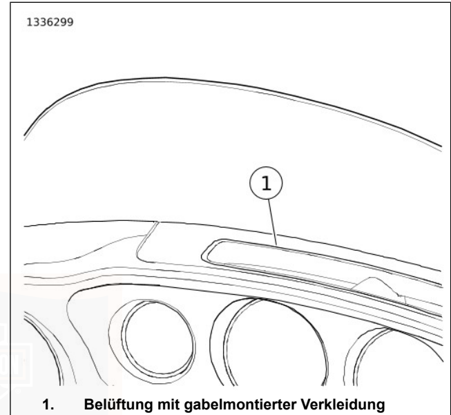
Abbildung 52. Splitstream Verkleidungsluftkanal (gabelmontierte Verkleidung)
