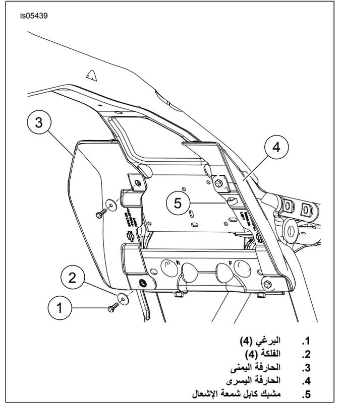
الشكل 2. تثبيت حارفات الهواء
