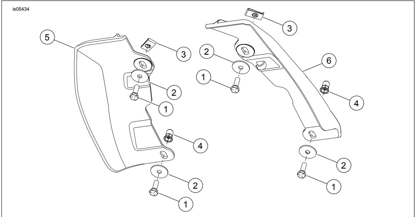
الشكل 3. قطع غيار الخدمة: حارفات الهواء في منتصف الإطار
