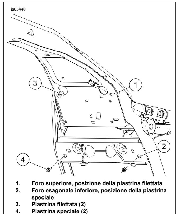
Figura 1. Posizioni dei dispositivi di fissaggio
