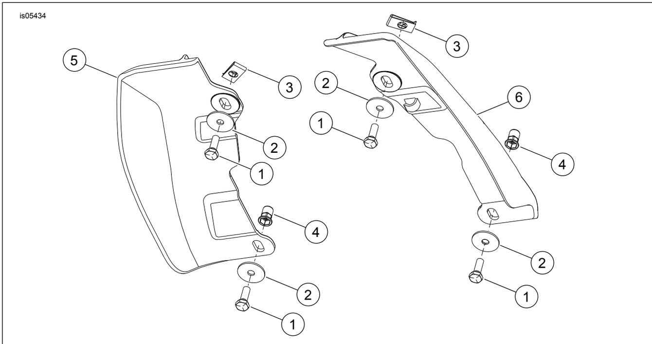
Figura 3. Parti di ricambio: Deflettori aria telaio intermedio
