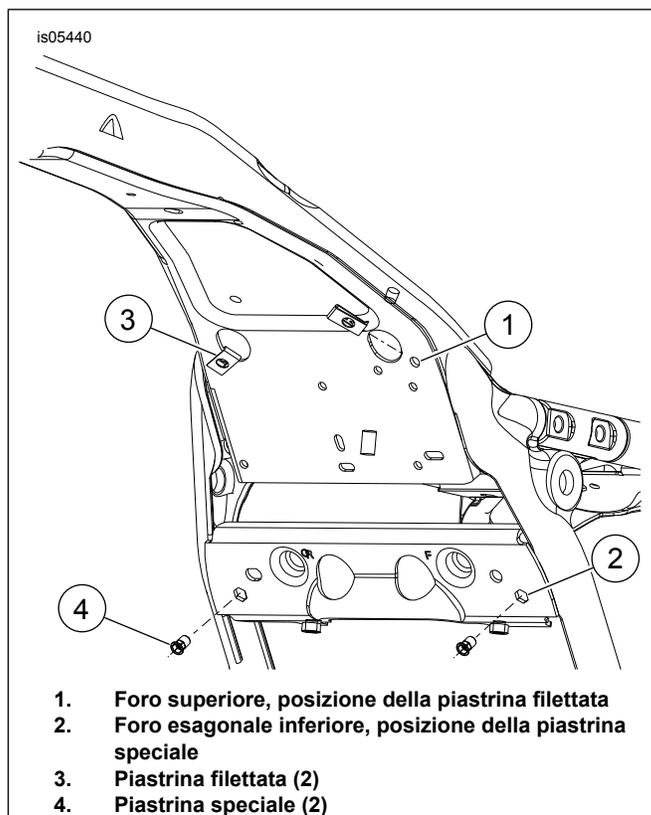
**Figura 2. Posizioni dei dispositivi di fissaggio**
