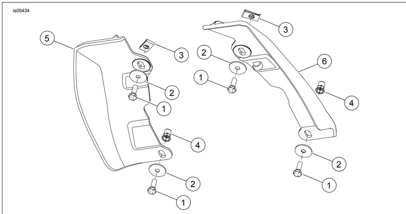
Figura 1. Contenuto del kit: Deflettori aria telaio intermedio
