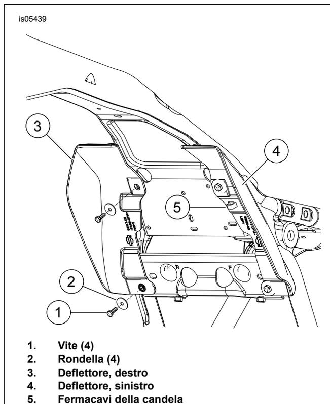
**Figura 3. Posizioni dei dispositivi di fissaggio**
