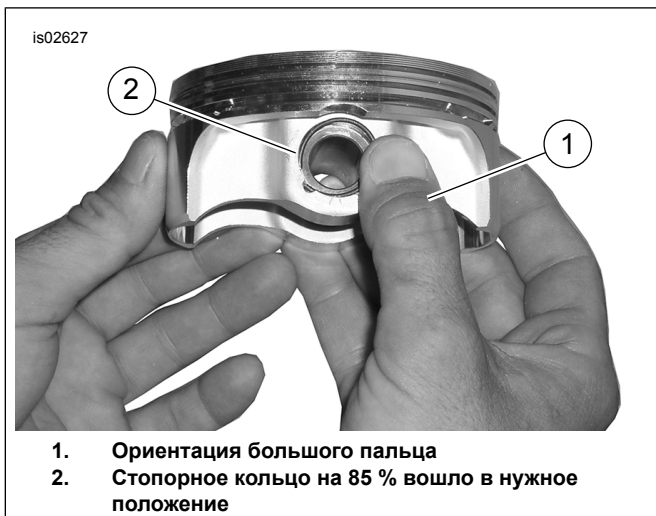
Рисунок 4. Установите стопорное кольцо
