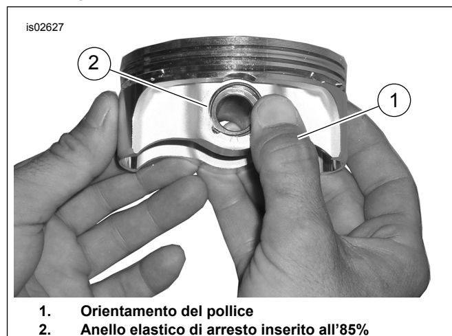
Figura 4. Installazione dell'anello elastico d'arresto
