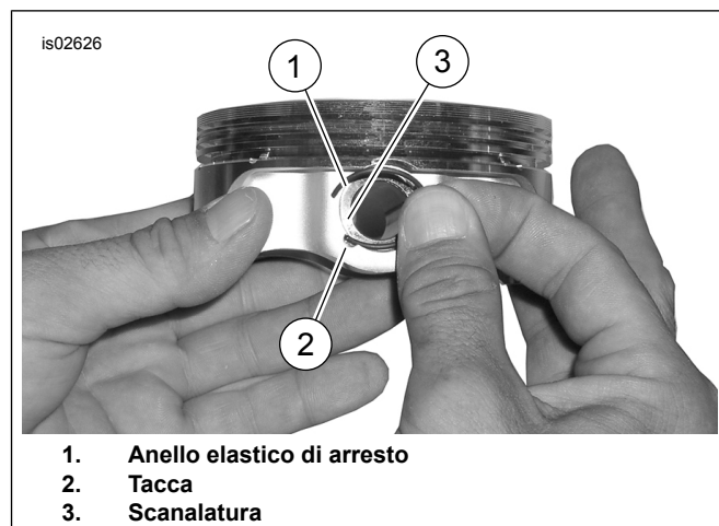
Figura 3. Anello elastico d'arresto e pistone
