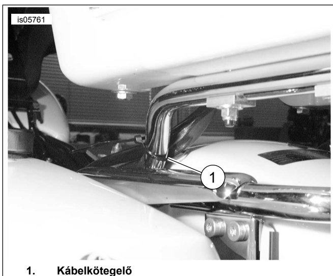
Ábra 9. A Tour-Pak kábelköteg rögzítése a tartósínhez
