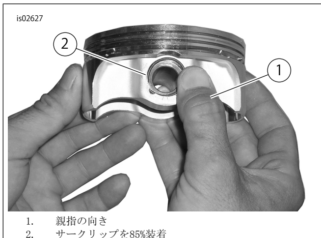
図4。サークリップの取り付け
