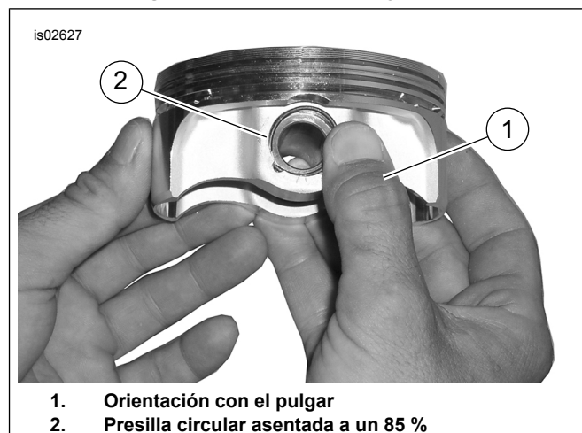
Figura 4. Instalación de la presilla circular
