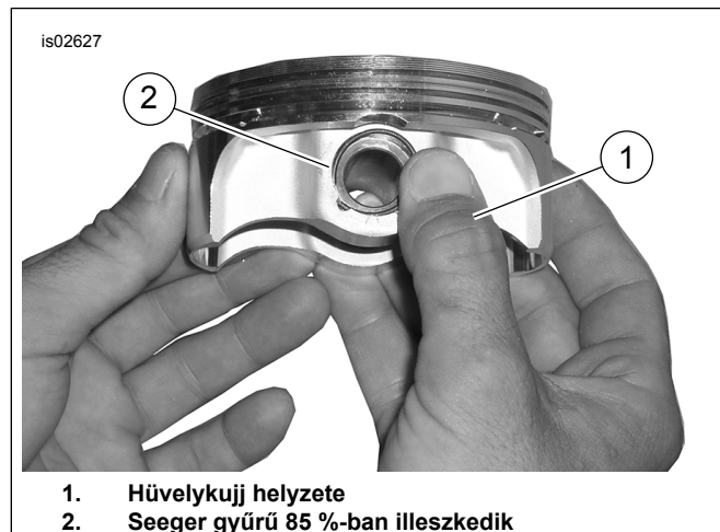
Ábra 4. Seeger gyűrű beszerelése
