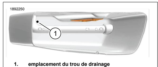
Figure 3. Placement du trou de drainage de la sacoche droite
