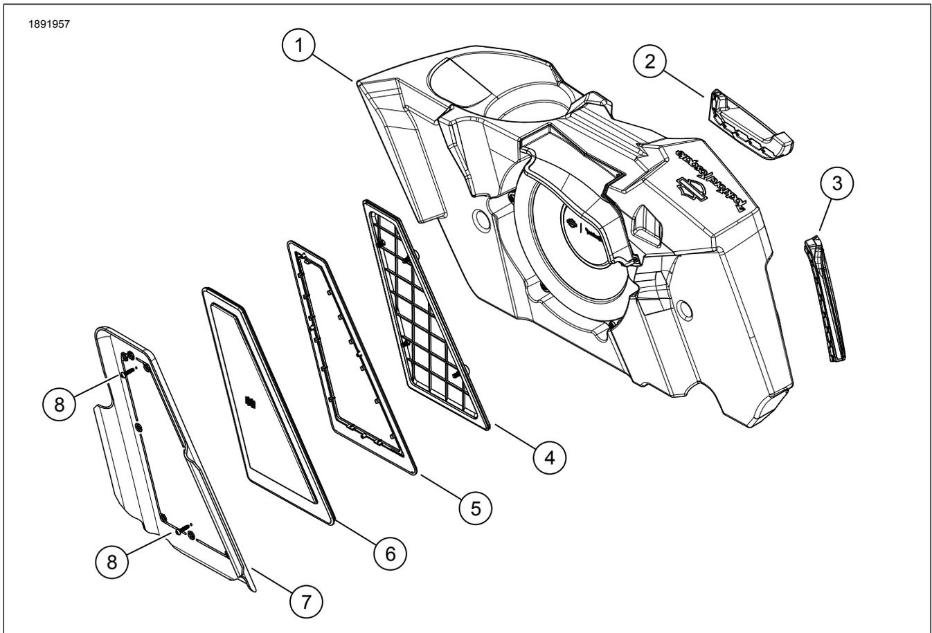
Figure 1. Contenu du kit : Kit de caisson de basses principal du système audio Harley-Davidson par Rockford Fosgate (sacoche droite)
