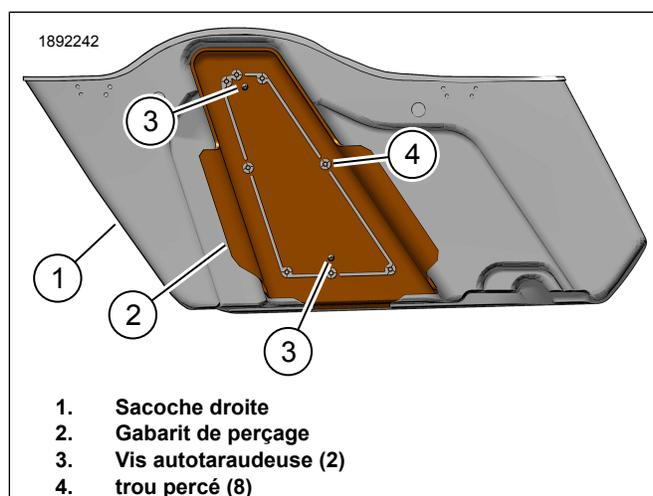
Figure 2. Gabarit de perçage de sacoche droite
