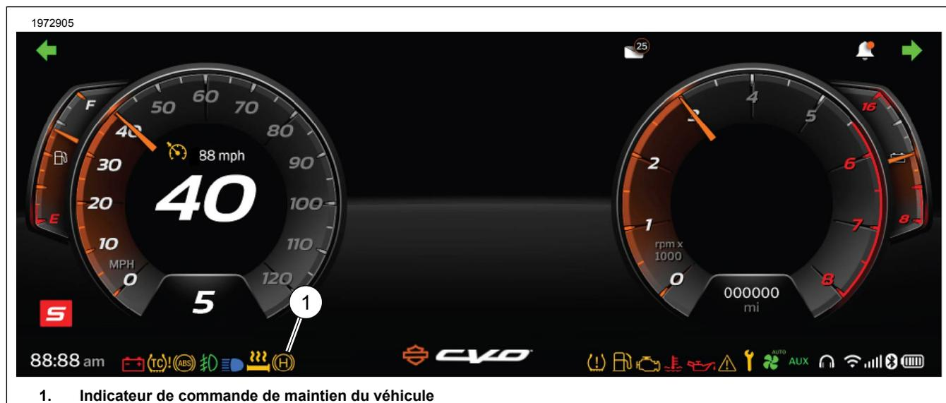
Figure 4. Témoin lumineux de maintien de la stabilité de la moto (VHC) : Véhicule avec unité de contrôle d'infodivertissement (IFCU)
