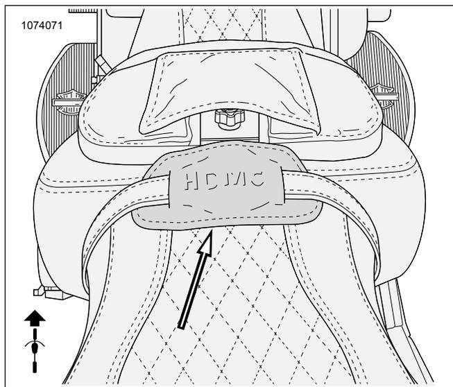
Figura 2. Cubierta de la perilla del ajustador instalada
