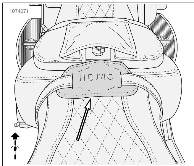
圖2。調節器旋鈕蓋已安裝
