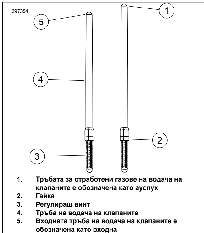
Фигура 1. Регулируеми водачи на клапани
