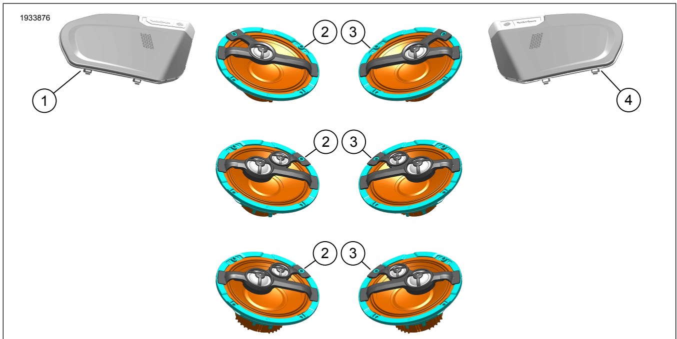
Afbeelding 1. Setinhoud: Stage I, II, III luidsprekerkit - op het frame gemonteerde kuip
