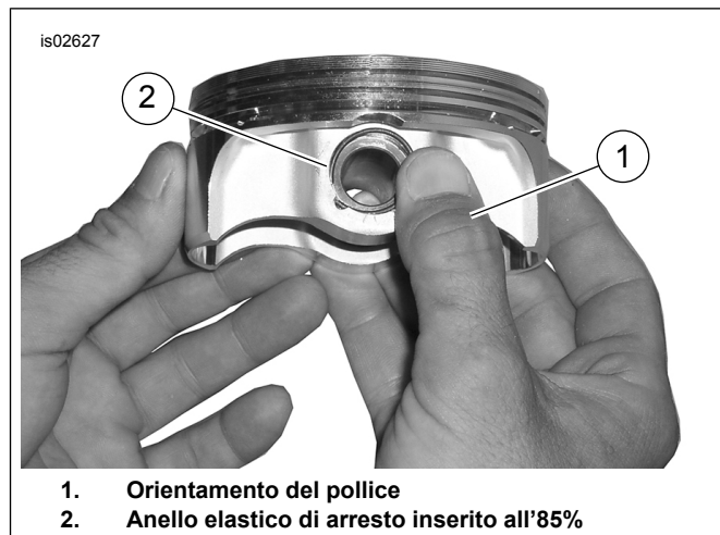
Figura 4. Installazione dell'anello elastico d'arresto
