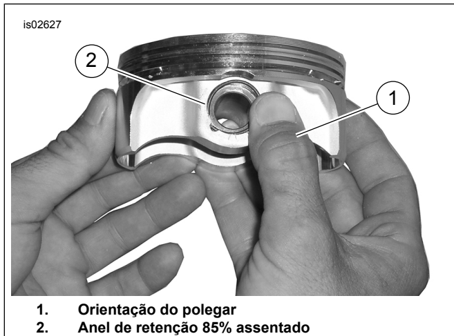
Figura 4. Instalação do anel de retenção
