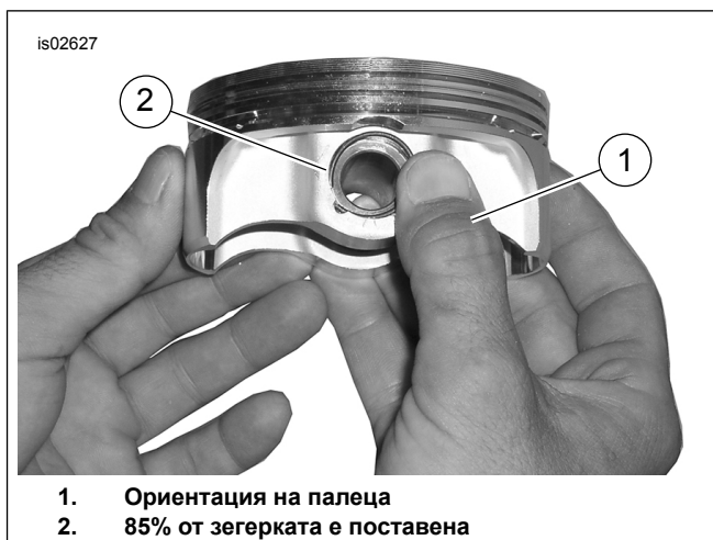
Фигура 4. Монтаж на зегерка
