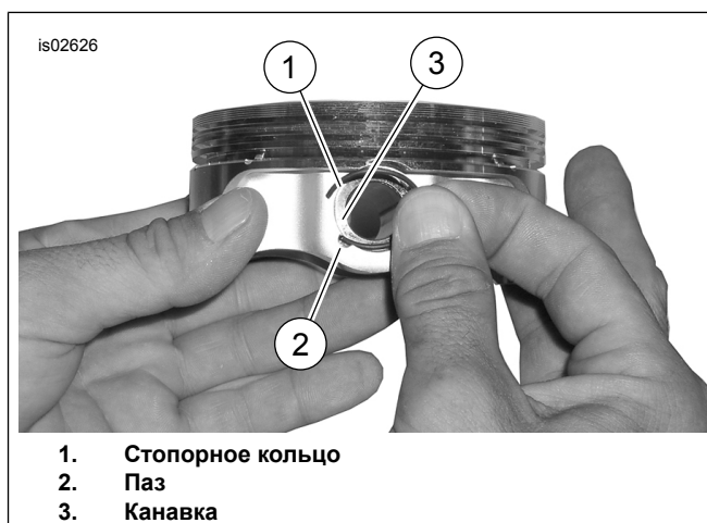
Рисунок 3. Стопорное кольцо и поршень
