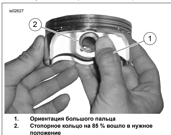
Рисунок 4. Установите стопорное кольцо
