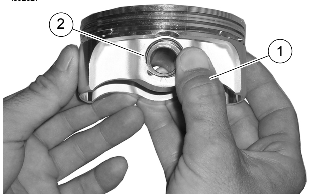
Slika 4. Postavljanje sigurnosnog prstena
