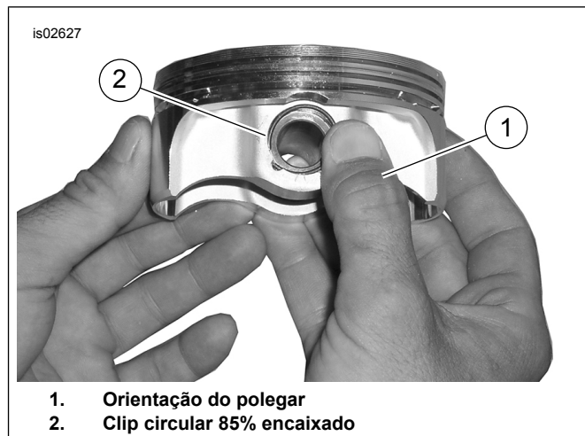
Figura 4. Instale o grampo circular
