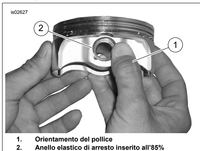
Figura 4. Installazione dell'anello elastico d'arresto
