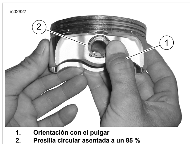
Figura 4. Instalación de la presilla circular
