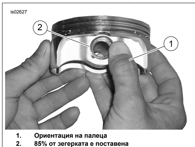
Фигура 4. Монтаж на зегерка
