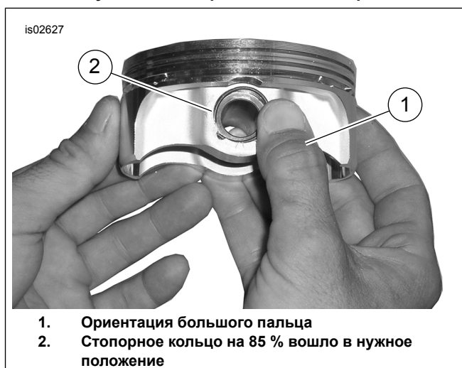
Рисунок 4. Установите стопорное кольцо
