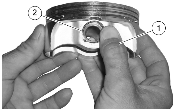
Figur 4. Montering af låsering
