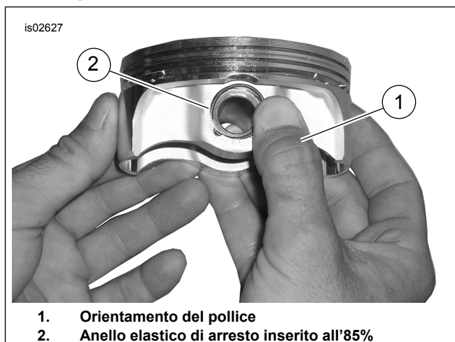
Figura 4. Installazione dell'anello elastico d'arresto
